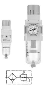
При давлении на входе 0.7 МПа, давлении на выходе при нулевом расходе 0.5 МПа и снижении давления на выходе при изменении расхода от нуля до номинального равном 0.1 МПа
