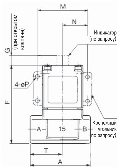
Клапан с размером порта 10A, 15A, 20A, 25A
