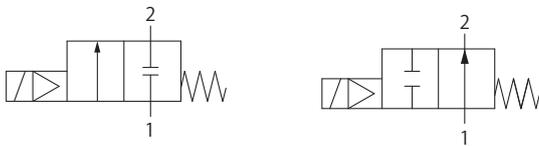
Когда клапан закрыт, поток среды не проходит в направлении от порта 1 (ВХОД) к порту 2 (ВЫХОД). Однако, если давление на выходе больше, чем на входе, клапан не сможет перекрывать поток и будет пропускать среду в направлении от порта 2 к порту 1
